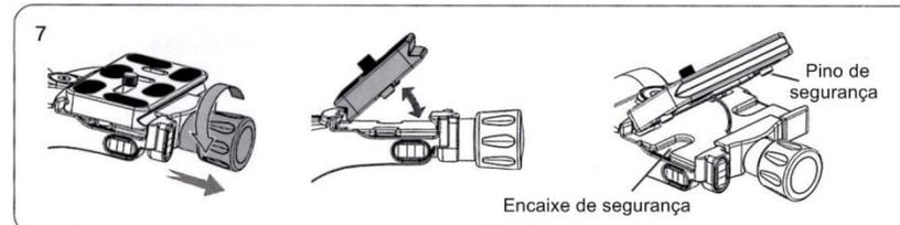
7. Para remover a placa, gire o botão do engate rápido em sentido anti-horário. Girando pouco o botão, a abertura parcial da braçadeira permite o movimento da placa para melhor posicionamento. Os dois pinos (removíveis) na base da placa conferem o primeiro nível de segurança.
