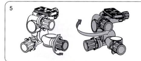
1. As rodas dentadas a, b e c servem para ajuste rápido da inclinação frontal, panorâmica e lateral. Gire no sentido horário para liberar o movimento e solte somente após posicionamento da cabeça.
